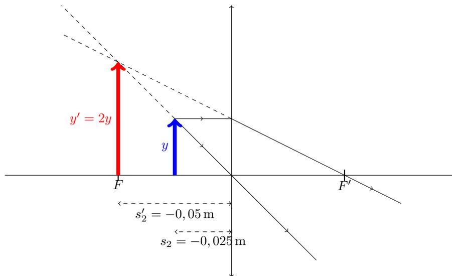
Por lo tanto, la posición final del objeto es  $s_2 = -0,025 \text{ m}$  y la distancia final entre la imagen y la lente es  $s'_2 = -0,05 \text{ m}$ .
